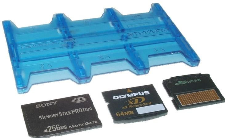
U Video-kameru magnetska kartica se ugrađuje zbog snimanja pojedinačnih fotografija, koje se s lošom (640x480) a ponekad i pristojnom razlučivošću mogu snimiti i za vrijeme snimanja videa. 2007. g. ustalile su se praktički tri od mnogih vrsta kartica za fotoaparate: **Secure digital** (mnogi sitni uređaji kao ručna računala, MP3 Playeri, GPS-ovi i dr, a za camcordere Canon), **xD Picture Card** (Olympus, Fujifilm) i **Memory stick Duo** koju koristi Sony.
