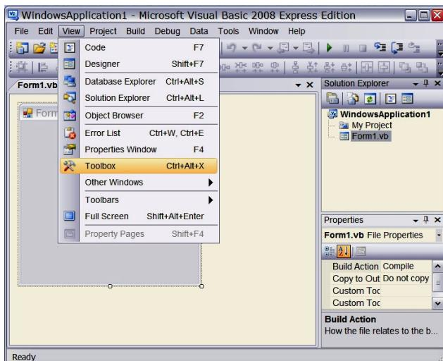
Obrazac ćemo kreirati prijenosom objekata iz okvira s objektima (**Toolbox**) na obrazac uz pomoć miša.
